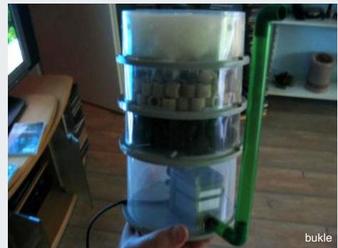
*DIY unutarnji filter za manji akvarij napravljen od kutija za CD-e, cijevi i pumpe za vodu*
